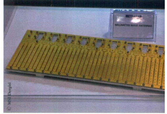
Meteksan Savunma, yakın alan anten ölçüm atelyası, başta MİLDAR olmak üzere çeşitli radar projeleri kapsamında yoğun olarak kullanıyor (solda). Geliştirilen milimetre dalga antenlerinden bir örnek (altta).
