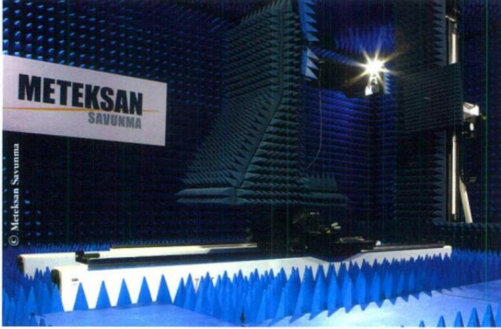
Meteksan Savunma, yakın alan anten ölçüm atelyası, başta MİLDAR olmak üzere çeşitli radar projeleri kapsamında yoğun olarak kullanıyor (solda). Geliştirilen milimetre dalga antenlerinden bir örnek (altta).
